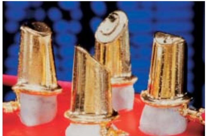
Abb. 8 Die galvanisierten Teile
