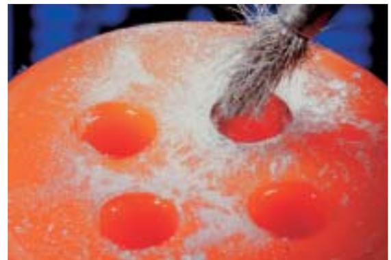
Abb. 4 Die trockene Duplierform wird mit Arcuplat-Silberpulver (Wieland Dental + Technik) und einem zerstaubten Pinsel der Größe 2 ausgepinselt.
